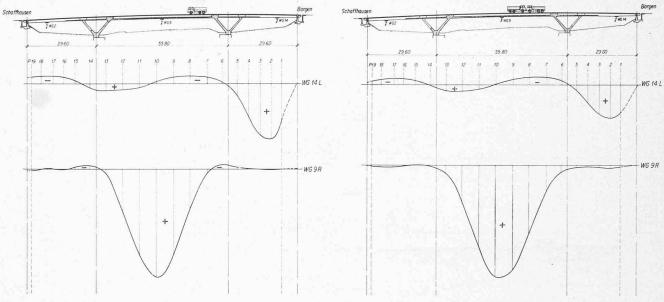
Bild 2. Summeneinflusslinien für Durchbiegungen bei zentrischer Belastung
