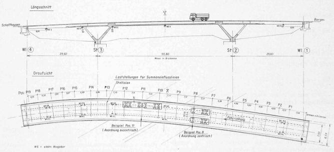
Bild 1. Abmessungen, Instrumentenanordnung und Laststellungen
