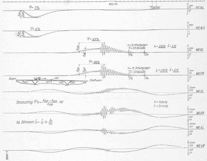
Bild 5. Durchbiegungsdiagramme für einige Messstellen der Brücke beim Sprungversuch,  $V=10\,\mathrm{km/h}$
