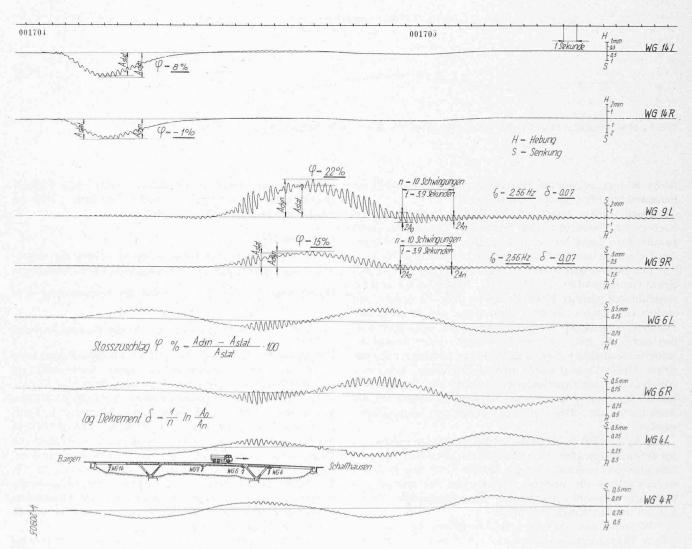
Bild 4. Durchbiegungsdiagramme für einige Messstellen der Brücke bei normaler Fahrt, V = 10 km/h
