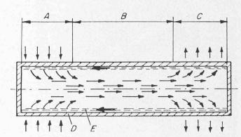
Bild 1. Prinzip des Wärmerohres. A Verdampfung, B Transportzone, C Kondensation, D Rohrwand, E Docht
