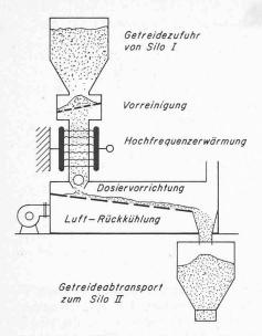
Bild 1. Schematische Darstellung einer Hochfrequenz-Entwesungsanlage
