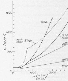
Bild 3. Schneelast  $p_r$  als Funktion der Meereshöhe H im geschichtlichen Überblick schweizerischer Normen vom Jahre 1892 bis 1976
