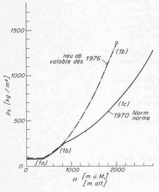
Bild 1. Neu vorgeschlagene (strichpunktiert gezeichnete Kurve) und bisher gültige (fest ausgezeichnete Kurve) Schneelast  $p_{\rm S}$  als Funktion der Höhe H in m ü. M.
