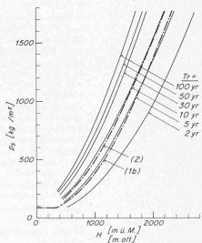
Bild 2. Gemessene, aber durch Ansätze ausgeglichene Extremwerte der Schneelasten  $p_{\rm S}$  als Funktion der Meereshöhe für die Wiederkehrsdauer  $T_{\rm T}\!=\!2$  Jahre, 5 Jahre, 10 Jahre, 30 Jahre, 50 Jahre und 100 Jahre. Strichpunktiert sind auch die Werte nach Gl. (1b) und (2) eingetragen
