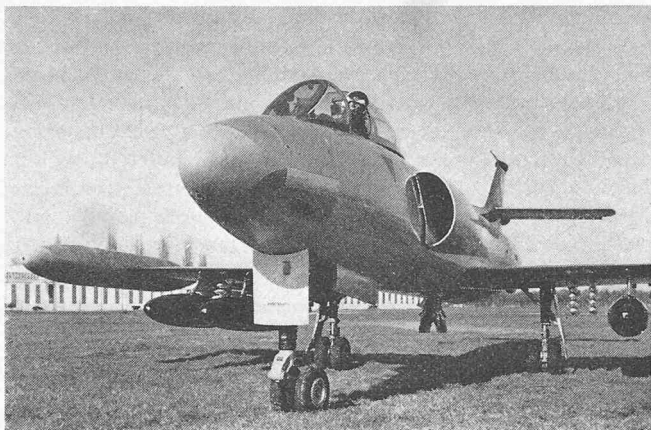
Bild 53. P-16 Mk III auf der Graspiste in Altenrhein. Angehängt sind vier Feuerbomben und 24 Raketen
