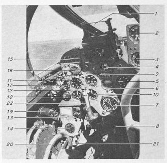
Bild 54. P-16 Mk III. Pilotenkabine. Auf der nicht mehr sichtbaren, rechten Konsole ist die Bedienung der Sauerstoff- und Waffenanlage angeordnet
