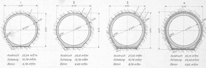
Bild 2. Druckstollen, grosses Profil. Profiltypen 1 bis 4 (s. Tabelle 1)
