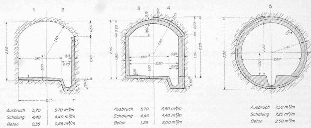
Bild 1. Freilaufstollen, Minimalprofil. Profiltypen 1 bis 5 (s. Tabelle 1)
