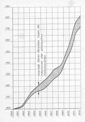
Bild 3. Bandbreite der Kostenindices für Stollenbauarbeiten
