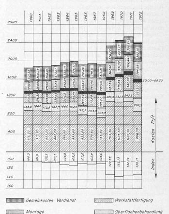
Bild 7. Druckleitung mit grosssem Durchmesser (über 150 cm). Kostenentwicklung zwischen 1960 und 1972, Die Legende gilt für die Bilder 5, 6 und 7
