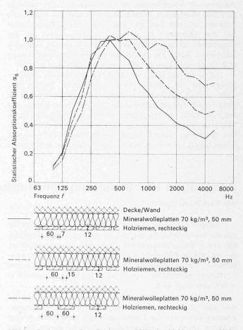
Bild 2. Optimal gestaltete Decken- und Wandverkleidungen aus Holzriemen weisen gute akustische Eigenschaften auf, die auf das Material selbst und auf seine Anordnung zurückzuführen sind
