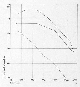
Die Verbesserung wird durch Hochlegen der Schüttung und federnde Aufhängung der Putzschale erreicht.
