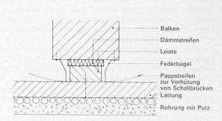
Bild 4. Vergleich zwischen einer normalen und einer verbesserten Ausführung unter Angabe der Konstruktionsdetails und der entsprechenden Trittschallisolationskurven (nach Gössele)
