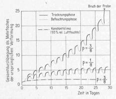
Bild 6. Einfluss einer wechselnden Holzfeuchte auf die zeitabhängige Biegeverformung von Birkenproben mit 2 mm × 2 mm Querschnitt. Befeuchtung und Trocknung durch Lagerung in 93 % bzw. 0 % rel. Luftfeuchte. P = Belastung im Verhältnis zur Kurzzeitfestigkeit
