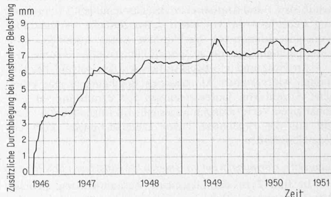
Bild 7. Zeitabhängige Verformungen eines Biegeelementes aus Tannenholz ohne Strukturstörungen mit einem Querschnitt von 5 cm × 5 cm und einer Spannweite von 90 cm. Maximale Spannung bei mittiger Belastung 338 kp/cm 2 , entsprechend ca. 40% der Kurzzeitfestigkeit. Ausgangsholzfeuchte: 12%. Darrdichte 0,455 g/cm 3 . Anfängliche Durchbiegung: 1,2 mm. Lagerung der Probe in einem relativ offenen Schuppen
