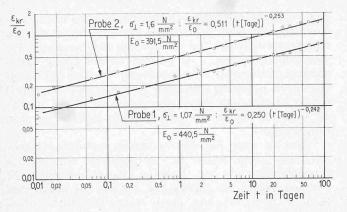
Bild 4. Querdruck-Zeitstandversuche an Abschnitten von lamellenverleimten Trägern aus Fichtenholz im Konstantklima  $20^{\circ}C/65\,\%$  rel. Luftfeuchte. Probengrösse  $L\times B\times H.$  Probe 1: 60 cm  $\times$  17 cm  $\times$  35 cm, Probe 2: 40 cm  $\times$  17 cm  $\times$  35 cm, Jahrringstellung der einzelnen Lamellen liegend bis 45°.  $E_0=$  Kurzzeit E-Modul.
