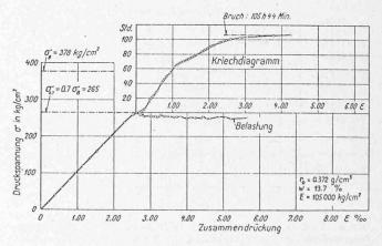
Bild 3. Längsdruck-Dauerversuch an Tannenholz bei einer Belastung von 70 % der Kurzzeitfestigkeit  $\tau_{\rm B}$ .
