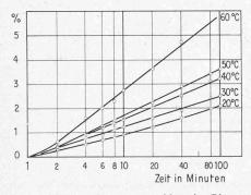
Bild 5. Zeit- und temperaturabhängige Biegeverformung von 30 cm  $\times$  2 cm  $\times$  1 cm–Stäben aus Weymouthsföhre
