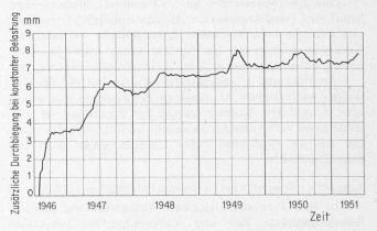
Bild 7. Zeitabhängige Verformungen eines Biegeelements aus Tannenholz ohne Strukturstörungen mit einem Querschnitt von 5 cm × 5 cm und einer Spannweite von 90 cm. Maximale Spannung bei mittiger Belastung 338 kp/cm², entsprechend ca. 40% der Kurzzeitfestigkeit. Ausgangsholzfeuchte: 12%. Darrdichte 0,455 g/cm³. Anfängliche Durchbiegung: 1,2 mm. Lagerung der Probe in einem relativ offenen Schuppen
