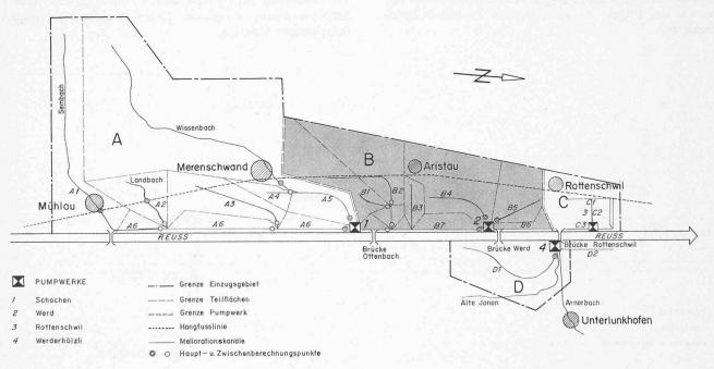
Bild 2. Schema der Querentwässerung (die Klischees für diesen Beitrag stammen aus WEW 4/5, 1974)
