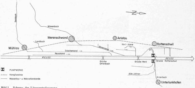
Bild 1. Schema der Längsentwässerung
