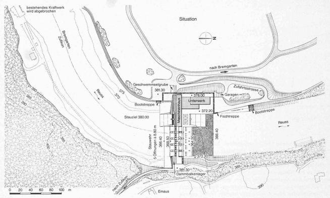
Bild 3. Lageplan von Maschinenhaus, Wehr und Unterwerk
