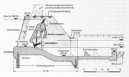
Bild 4. Längsschnitt durch das Stauwehr
