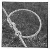
Dieses neue Bremselement wird in die Aufhängeseile eingebaut. Es absorbiert die Energie und hält die übertragenen dynamischen Kräfte klein. Die Schutzwirkung wird dadurch bei geringem Kostenaufwand wesentlich erhöht. Das Bremselement (Patent angemeldet) lässt sich in jedes schlagbeanspruchte Drahtseil einbauen, auch überall dort, wo die maximale Last begrenzt werden soll.
