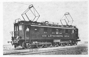
Bild 1 (links). 2'Bl'-Lokomotive Nr. ES 2 der KPEV für die Strecke Dessau-Bitterfeld (1910, 15 kV/16²/3 Hz bzw. anfänglich 10 kV/15 Hz, 660 kW Stundenleistung bei 79 km/h, 110 km/h Höchstgeschwindigkeit, 73 t Dienstmasse). – Bild 2 (rechts). C'C'-Lokomotive Ce 6/6 Nr. 121 der BLS (1910, 15 kV/16²/3 Hz bzw. anfänglich 15 Hz, rd. 1500 kW Stundenleistung bei 42 km/h, 60 km/h Höchstgeschwindigkeit, 90 t Dienstmasse)
