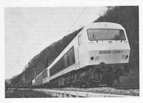
Bild 15. Das 2'2'+Co'Co'-Versuchsfahrzeug «Steuerwagen + DE 2500» (DB + BBC Mannheim) mit Umrichter und Drehstrom-Fahrmotoren (1974, 15 kV/16²/<sub>3</sub> Hz, rd. 1300 kW Stundenleistung im Bereich von 25 bis 140 km/h, 140 km/h Höchstgeschwindigkeit, 54 und 80 t Dienstmasse)
