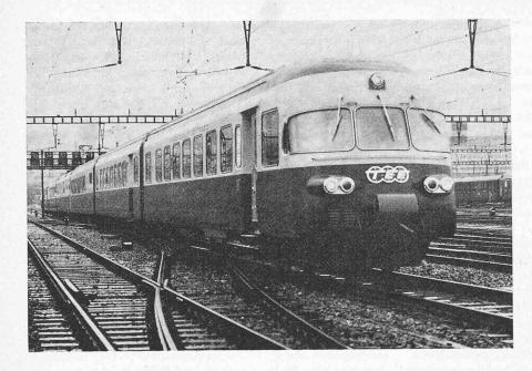
Bild 10. TEE-Viersystem-Triebwagenzug der SBB, Serie RAe (1961 und 1967, 15 kV/ $16^2$ /s Hz, 25 kV/50 Hz, 1500 V = und 3000 V =, 2376 kW Stundenleistung bei 88 km/h, 160 km/h Höchstgeschwindigkeit, 296 t Dienstmasse)
