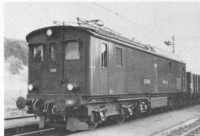
Bild 13 (links). Bo'Bo'-Lokomotive der ÖBB, Reihe 1044 (1974–1975, 15 kV/16 \frac{2}{3} Hz, 5400 kW Stundenleistung bei 90 km/h, 160 km/h Höchstgeschwindigkeit, 83 t Dienstmasse). – Bild 14 (rechts). Bo'Bo'-Lokomotive Be 4/4 Nr. 12001 der SBB mit Umrichter und Drehstrom-Fahrmotoren (1972, 15 kV/16 \frac{2}{3} Hz, rd. 1000 kW Stundenleistung im Bereich von 28 bis 75 km/h, 75 km/h Höchstgeschwindigkeit, 64 t Dienstmasse)
