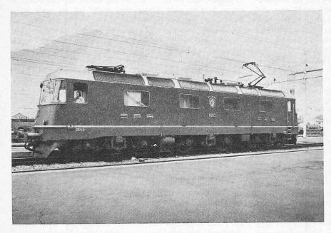
Bild 12. Bo'Bo'Bo'-Lokomotive der SBB, Serie Re 6/6 (1972 und ab 1975, 15 kV/16²/s Hz, 8028 kW Stundenleistung bei 106 km/h, 140 km/h Höchstgeschwindigkeit, 120 t Dienstmasse)
