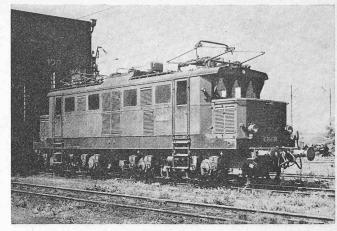
Bild 5 (links). Bo'Bo'-Lokomotiven der früheren PO, Serie E 101–180 (1925–1927, 1500 V=, 1300 kW Stundenleistung bei 47 km/h, 90 km/h Höchstgeschwindigkeit, 77 t Dienstmasse). – Bild 6 (rechts). Bo'Bo'-Lokomotive Nr. E 244.31 der nachmaligen DB (1936, 20 kV/50 Hz, 1840, 2120 oder 2020 kW Stundenleistung bei 33,2, 57,0 oder 80,0 km/h, 85 km/h Höchstgeschwindigkeit, 83 t Dienstmasse)
