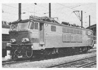
Bild 9 (links). Bo'Bo'-Lokomotive der BLS, Serie Ae 4/4 (1944–1955, 15 kV/162/5 Hz, 2944 kW Stundenleistung bei 76 km/h, 120 km/h Höchstgeschwindigkeit, 80 t Dienstmasse). – Bild 11 (rechts). Bo'Bo'-Viersystem-Lokomotive der SNCB, Reihe 16 (1966, 3000 V=, 1500 V=, 25 kV/50 Hz und 15 kV/162/5 Hz, 2800 kW Stundenleistung bei 89 km/h, 160 km/h Höchstgeschwindigkeit, 83 t Dienstmasse)
