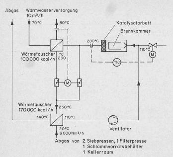
ebenfalls unerwünscht sind. Mit Hilfe der katalytischen Nachverbrennung und unter Einsatz von speziellen Katalysatoren ist es jedoch möglich, die stickstoffhaltigen Verbindungen selektiv zu Stickstoff und Wasser zu oxidieren. Ausserdem ist die bei der katalytischen Nachverbrennung anfallende Wärme, die in einer Kläranlage nicht genutzt werden kann, geringer als bei der thermischen Nachverbrennung, so dass ein geringerer Energiebedarf auftritt.
