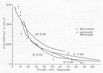
Bild 6. Drainabfluss Rezessionskurven für Gurnigelbad, Schacht S 5
