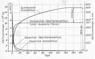
Bild 8. Abflussdauer- und Abflusssummenlinie
