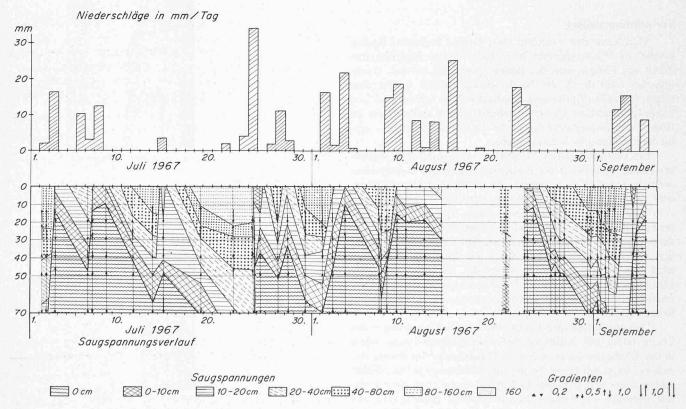
Bild 3. Saugspannungsverlauf in Drainbeetmitte
