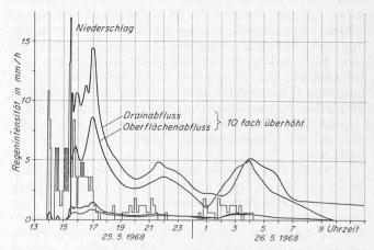
Bild 7. Abflussganglinien während eines natürlichen Regens. Die beiden unteren Ganglinien zeigen den Drain- und Oberflächenabfluss im gleichen Massstab wie den Regen
