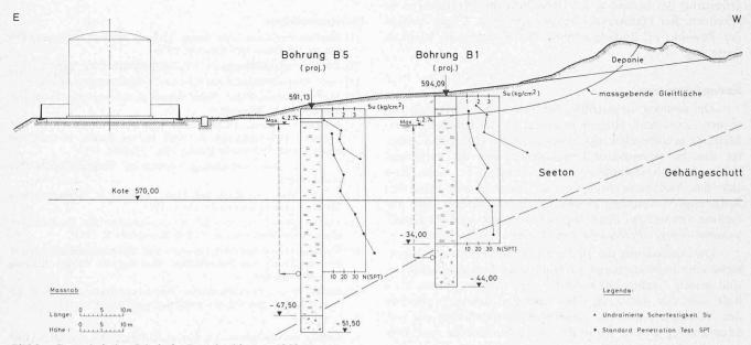
Bild 2. Geotechnischer Schnitt im Rutschgebiet von 1966
