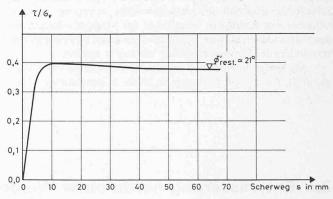
Bild 5. Ringscherversuch Probe 34 605
