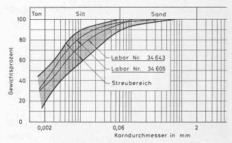
Bild 3. Kornverteilungen des Seetons
