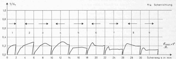
Bild 6. Direktscherversuch Probe 34 643
