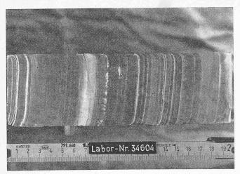
Bild 7. Aufgeschnittene und angetrocknete, ungestörte Probe des Sectons. Ausgesprochene Feinschichtung erkennbar
