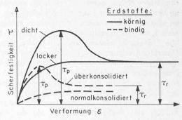
Bild 1. Qualitativer Verlauf der Scherfestigkeitsdiagramme verschiedener Erdstoffe
