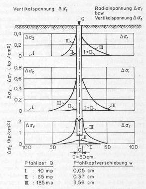
Bild 9. Änderung der Spannungsverteilung an einem Bohrpfahl
