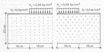
Bild 7. Flächenlasten auf weichem, kohäsivem Untergrund, links: Versuch, rechts: Rechnung
