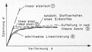
Bild 3. Stoffansätze für normal konsolidierte bindige und näherungsweise kritisch dicht gelagerte körnige Böden
