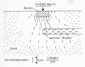
Bild 6. Verschiebungen unter einem Streifenfundament (nach [4])
