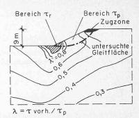
Bild 8. Standsicherheitsuntersuchungen einer Böschung in überkonsolidiertem Ton
