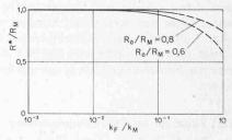
Bild 11. Darstellung des äquivalenten Filterrohrhalbmessers  $R^*$  für ein siebartig gedachtes Rohr gleicher Ergiebigkeit in Abhängigkeit von der Filterabstufung
