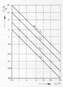
Bild 13. Einfluss des Sickeröffnungsanteils an der Rohrmantelfläche auf die Erhöhung des Längstransportwiderstands infolge des Sickerwassereintritts
