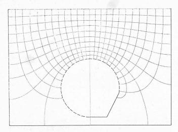
Bild 3. Potentialnetze für scheitelgefüllte Filterrohre im Rohrgraben, links: Vollfilterrohr; rechts: Teilfilterrohr
