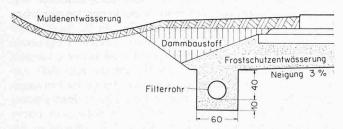
Bild 1. Beispiel einer Frostschutzentwässerung nach Fertigung der Strassendecke
