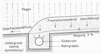
Bild 2. Bemessungsfall: Frostschutzentwässerung vor Aufbringen der Fahrbahndecke
