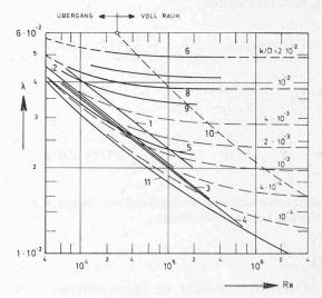
Bild 12. Widerstandsverhalten verschiedener Filterrohre
