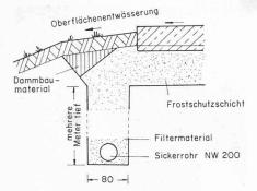
Bild 7. Beispiel einer Tiefensickerleitung
