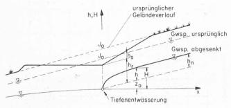
Bild 8. Bemessungslage für die Tiefenentwässerung beim Einschnitt und einseitiger Hanglage. Ursprüngliche Situation vor dem Einschnitt: Parallel zur Hanglage mit Gefälle  $J_0$  verlaufender Grundwasserstrom. Annahme nach Verlegen des Tiefensickers: Nur der Grundwasserstrom oberhalb der durch das Filterrohr gehenden und unter  $J_0$  geneigten gedachten Begrenzungslinie (gestrichelt) wird vom Rohr aufgenommen, der unterhalb derselben befindliche Reststrom fliesst unter dem Rohr hindurch weiter
