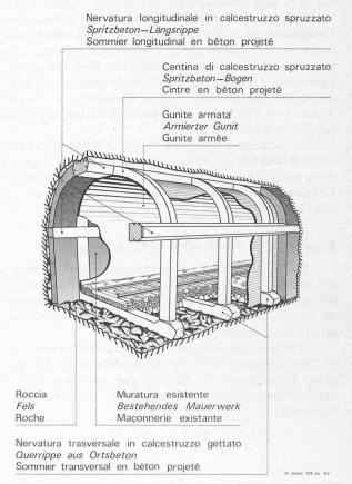
Bild 12. Vorgehen bei der Aussteifung des Tunnels Ruinacci
