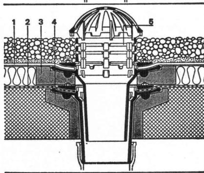
Standard-Dachablauf zweiteilig mit Isolierkörper und Isolierring und Distanzringen. Seitlicher Auslauf 3°
