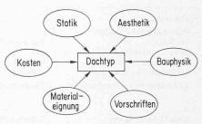
Bild 1. Bereiche für die Beurteilung einer Dachkonstruktion
