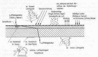
Bild 2. Bauphysikalische Einflüsse auf ein Flachdach
