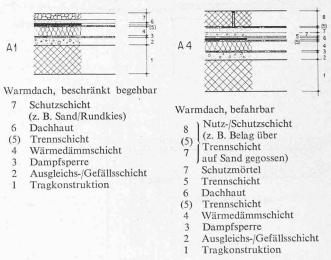
Bild 3. Typische Anordnung der Elemente des Flachdaches
