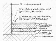
Detailschnitt, Dachhautaufbordung an Brüstung; ausgeführte Konstruktion, die zum Schaden führte
