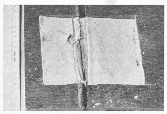
Dachunterseite, Probe mit Wulstbildung und bitumenfrei extrahiertem Ausschnitt, entnommen aus der Dachhaut über einer Fuge zweier Wärmedämmplatten; Trägermaterialien (Rohfilzpappe) der Bitumen-Dichtungsbahnen im Bereich des Wulstes, d. h. über der Plattenfuge, gerissen, verrottet und brüchig
