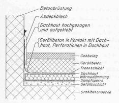
Detailschnitt, Dachhautaufbordung an Brüstung; ausgeführte Konstruktion, die zum Schaden führte
