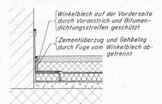
Ausführung und Konstruktion, durch die Korrosionen beim Winkelblech vermieden werden können
