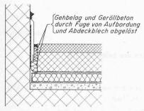
Konstruktion, durch die Kräfteübertragungen auf die Dachhautaufbordung durch Bewegungen des Geröllbetons und des Gehbelages vermieden werden können
