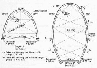
Bild 10. Messeinrichtung im Paramentstollen
