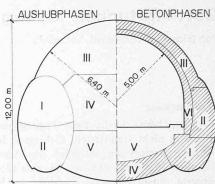
Bild 4. Tunnelprofil im Bereich des «Mesozoikums»
