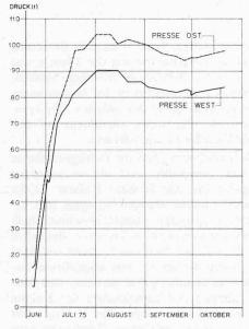
Bild 14. Kalottenbogen: Auflagerkräfte eines Bogens
