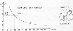
Bild 19. Nachgiebigkeit der Einbauten in den verschiedenen Bauetappen und Stabilisierungsdrücke. Berechnungsannahmen:
