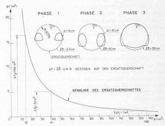
Bild 18. Zusammenhang zwischen Ausbruchphasen und Verformung. Berechnungsannahmen:
