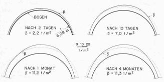
Bild 17. Kalottenbogen: den Messungen entsprechende Belastungen
