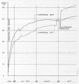
Bild 11. Druckmessungen im Bogen 1 (km 4,324)
