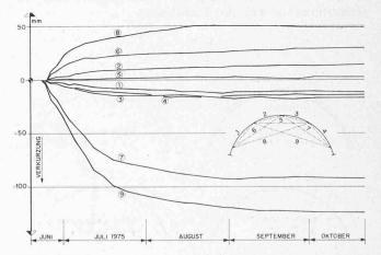
Bild 15. Kalottenbogen: Konvergenzmessungen
