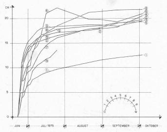
Bild 16. Kalottenbogen: Zusammendrückung des Hohlraums
