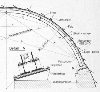
Bild 13 (oben). Messeinrichtung in der Kalotte
