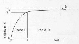
Bild 2. Schematische Darstellung der Klarwasserkolk-Entwicklung
