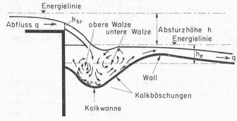
Bild 1. Schematisches Kolkbild
