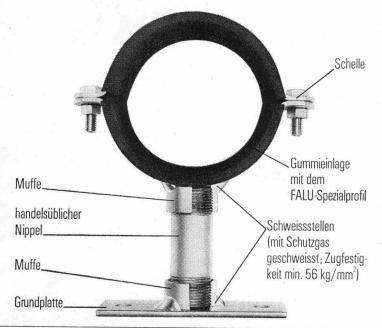
Dank dem Schutzgas-Schweissverfahren, bei dem wir Schweissmaterial von hoher Qualität und mindestens 56 kg/mm² Festigkeit an den Schweissstellen zuführen, können FALU-Rohrschellen einer hohen Belastbarkeit ausgesetzt werden.
