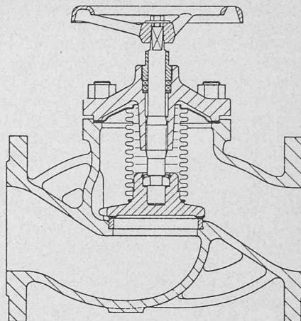
anlagen mit anderen flüssigen Wärmeträgern als Wasser durchgeführt und dem «Boa-Wartungsfrei» das TÜV-Prüfzeichen «b004» zuerkannt. Über die in DIN 2401 für GG-20 und GG-38 festgelegten zulässigen Betriebsdrücke hinaus können die neuen «Boa-Wartungsfrei» ND 16 aus Meehanite-Guss GG-25 aufgrund der höheren Festigkeit bis 300 °C, 16 bar, und aus Meehanite-Guss GGG-40.3 bis 350 °C, 10 bar, eingesetzt werden.
