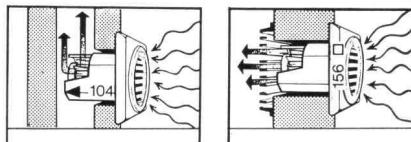
Der kleinste, preisgünstige Druck- ventilator mit der grossen Leistung: 100 m<sup>3</sup>/h. Für Neubauten und nachträglichen Einbau an bestehende Luftkanäle. Lageun- abhängig. Modelle für Einbau- rohre von 100 und 115 mm Ø, mit oder ohne Verschluss, Kontroll- lampe und Zugschalter.
