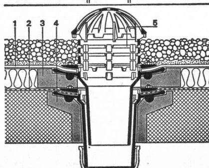
Standard-Dachablauf zweiteilig mit Isolierkörper und Isolierring und Distanzringen. Seitlicher Auslauf 3°
