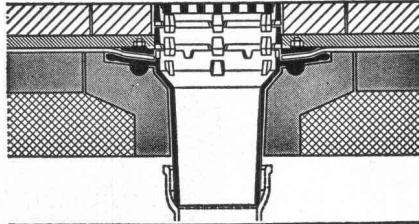
Standard-Dachablauf zweiteilig mit Isolierkörper und Isolierring und Distanzringen 25 und 35 mm H mit Kugelrost
