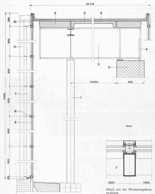
Hallenbad Frauenfeld. Einzelheiten der Dach- und Fassadenkonstruktion. 1 Stahlrohrstützen Ø 22 cm, 2 Betonstützen, 3 Stahlträger HEA 900, 4 Zuganker Ø 30 mm, 5 vorfabrizierte Betondachelemente, 6 Flachdach, Isolation mit Kunststoffolie, 7 Fassadenpfosten in Aluminium, 8 Fassadenriegel in Aluminium, 9 Isolierverglasung teilweise sekurisiert, 10 Dachrandverkleidung isoliert, 11 Dachwasserablauf mit Aluminiumverkleidung
