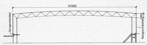
Tragsystem der Fachwerkträger für die neue Sporthalle der ETS Magglingen. Querschnitt durch die Halle. Die Vorspannkabel ziehen die Fachwerkträger nach unten und entlasten damit das Fachwerk im Mittelbereich
