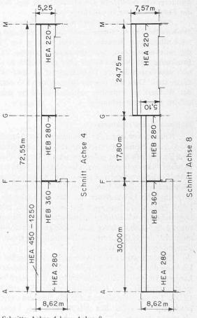
Schnitte Achse 4 bzw. Achse 8
