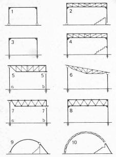
Statische Systeme für Sporthallen. 1, 2: Zweigelenkrahmen; 3, 4: beidseitig eingespannter Rahmen; 5, 6: beidseitig frei aufliegender Binder auf eingespannten Stützen; 7, 8: allseitig aufliegende Raumfachwerke; Spielart a: Obergurt aufliegend, Spielart b: Untergurt aufliegend; 9, 10: Zweigelenkbögen
