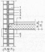
Normalschnitt 1:35 durch Aussenmauer und Innenwand. 1 Backstein, 2 Luftspalt, 3 Mineralwolle, 4 Pretonelement, 5 Ortbeton, 6 Verputz, 7 Kittfuge. Masse in cm
