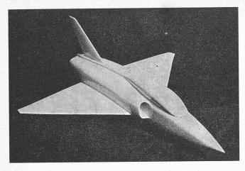
Bild 30. Windkanalmodell der Studie L-10 III/V für Leichtkampfflugzeuge
