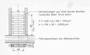
Bild 3. Aufprallblock unter dem Gegengewicht eines Aktenaufzuges (ausgeführtes Beispiel)
