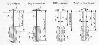
Bild 2. Schematische Darstellung der eingebauten Versuchsanker
