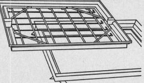
Für den Bauausführenden: Keine Probleme beim Einbau! Die Nenngrössen passen sich entweder den verschiedensten Plattenformaten von Fussbodenbelägen an oder weisen den Vorschriften entsprechende Mauermasse für die lichte Schachtweite auf.
