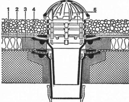
Standard-Dachablauf zweiteilig mit Isolierkörper und Isolierring und Distanzringen. Seitlicher Auslauf 3°
