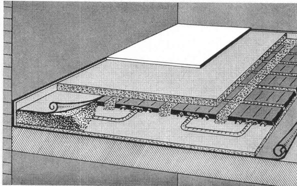
Schnittzeichnung durch die neue Konstruktion bei Unterlagsböden:
