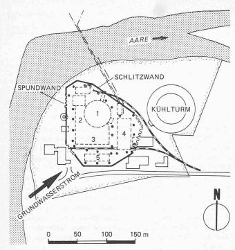
Bild 2. Baugrubenumschliessung mit Filterbrunnen
