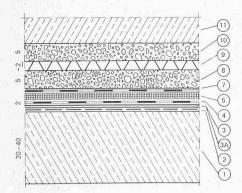
Bild 3. Grundwasserisolierung der nuklearen Gebäude
