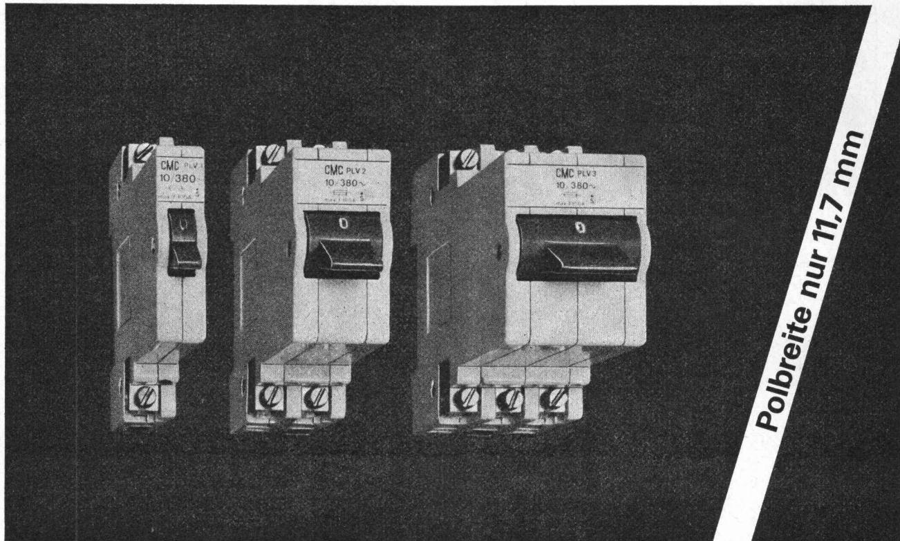
Der Picomat ist der ideale Sicherungsautomat in Kleinmaschinen-Steuerungen und Wohnverteilern. Schnappbefestigung, vielseitiges und praktisches Montage- und Anschluss-Zubehör erlauben Ihnen, leichter und sauber zu installieren. Alle Ausführungen für Leitungs- und Geräteschutz sind bis 25 A 380 V~ erhältlich; bei 380 V~ beträgt die Abschaltleistung 3000 A. Der Typ PLV kann neu mit einer 100 A-Vorsicherung verwendet werden.
