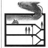
Sicherer Ab- und Zugang dank entlüfteten Treppenräumen. Cupolux-Lichtkuppeln
