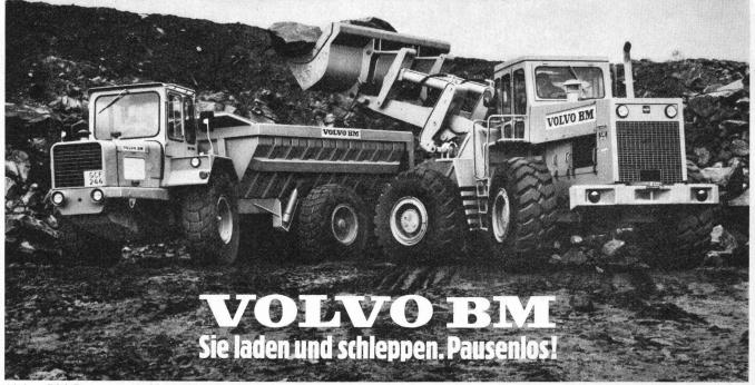
Volvo BM Dumper mit 11,0 m³ Mulde für jeden Einsatz. Volvo BM Pneulader von 7–17 Tonnen mit über 80 Zusatzgeräten. Automobiles Volvo SA. Industriering, 3250 Lyss, Abteilung Baumaschinen, Telefon 032 847111
