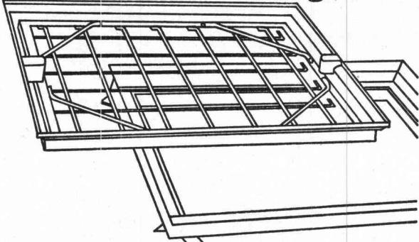
**Für den Bauausführenden:** Keine Probleme beim Einbau! Die Nenngrößen passen sich entweder den verschiedenen Plattenformaten von Fußbodenbelägen an oder weisen den Vorschriften entsprechende Mauermasse für die lichte Schachtweite auf.
