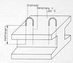
Bild 8. Einbetonierte Seile, Beispiel aus der Praxis
