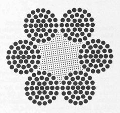
Bild 3. Querschnitt des untersuchten Seiltyps von 90 mm Durchmesser
