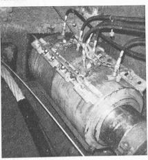
Bild 2. Zerrissenes Seil nach dem Entfernen der Presse
