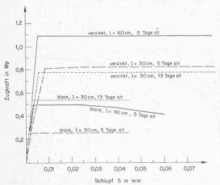
Bild 9. Draht-Ausziehversuche (1 Haftstrecke im Mörtel)
