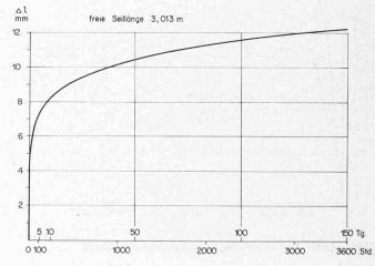
Bild 6. Verformungszunahme über die freie Kabellänge, ausgehend von der Dehnung 55,3 mm nach dem raschen Aufbringen der Dauerlast von 210 Mp
