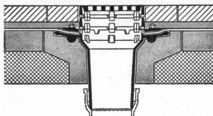
Standard-Dachablauf zweiteilig mit Isolierkörper und Isolerring und Distanzringen 25 und 35 mm H mit Kugelrost
