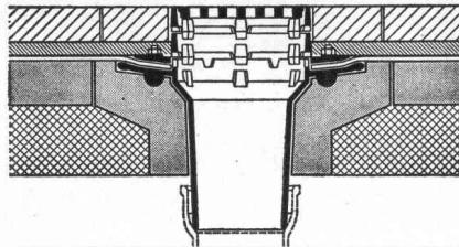
Standard-Dachablauf zweiteilig mit Isolierkörper und Isolierring und Distanzringen 25 und 35 mm H mit Kugelrost
