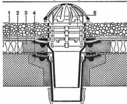
Standard-Dachablauf zweiteilig mit Isolierkörper und Isolerring und Distanzringen. Seitlicher Auslauf 3°
