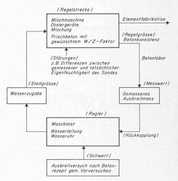
Bild 1. Regelkreis zur Steuerung von Wasser-Zement-Wert und Konsistenz
