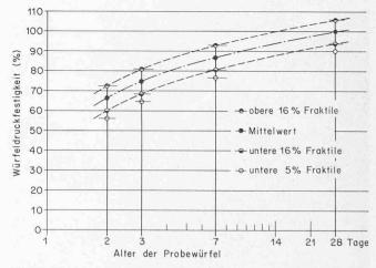
Bild 5. Festigkeitsentwicklung des Standardbetons B. Ergebnisse der 10-Jahres-Statistik
