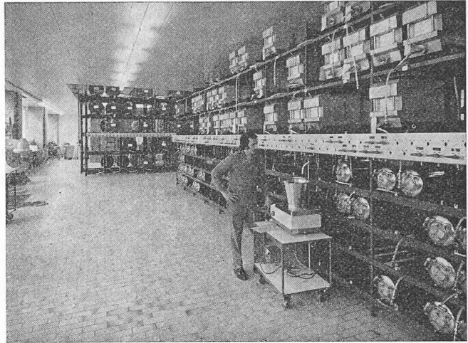
Aromenausmischung (Manipulation). Für mittlere Mengen werden die Rohstoffe aus Bidons mittels Stickstoff direkt auf fahrbare Waagen gedrückt
