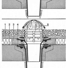
Standard-Dachablauf zweiteilig mit Isolierkörper und Isolierring und Distanzringen 25 und 35 mm H mit Kugelrost
