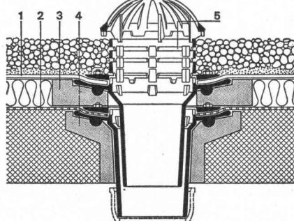
Standard-Dachablauf zweiteilig mit Isolierkörper und Isolierring und Distanzringen. Seitlicher Auslauf 3°
