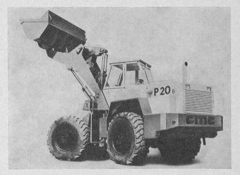
Weitere Merkmale, die besonders hervorgehoben zu werden verdienen, sind: die Verwendung luftgekühlter Dieselmotoren, die serienmässige, wirkungsvolle Schalldämpfung, die nach dem Orbitrol-System arbeitende hydraulische Knicklenkung mit grossem Lenkeinschlag, die Allrad-Scheibenbremsen mit automati-
