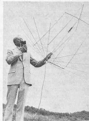
sierter Helixantenne. Die Sendeleistung des für die Vorführung verwendeten Hilfssatelliten beträgt 40 W, die Signalverstärkung seiner linearpolarisierten Antenne ungefähr 8 db. Bedingt durch die Antennenkonstruktion am Satelliten, war es beim Versuch nur möglich, vom Handfunkgerät durch Drücken der Sprechtaste einfache Ein-Aus-Rechtecksignale in Morsecode zu senden. Änderungen am Antennensystem des Satelliten sollen jedoch beidseitigen, atmosphärisch ungestörten Sprechfunk ermöglichen.
