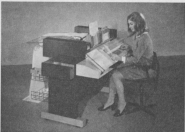
Philips Office-Computer P 359 mit einer Speicherkapazität von wahlweise 600 oder 1000 Worten zu 16 Stellen
